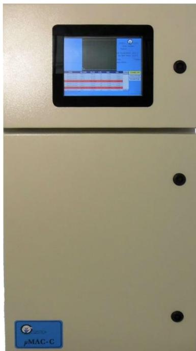
**MICROMAC C AMMONIA** – это современный промышленный анализатор, управляемый микропроцессором в режиме реального времени, разработанный специально для автоматического мониторинга аммонийного азота в образцах сточных, природных и питьевых вод.
