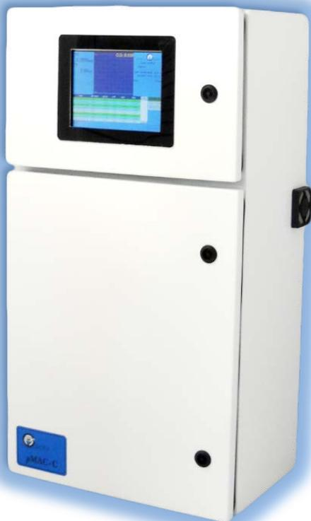
MICROMAC C MP4 – это современный промышленный анализатор, управляемый микропроцессором в режиме реального времени, разработанный специально для автоматического мониторинга ионов аммония, нитратов, нитритов и ортофосфатов в образцах сточных, природных и питьевых вод.
