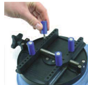
Зажимы легко настраиваются под размеры образца.
