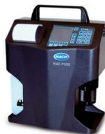
HIAC PODS переносная система диагностики масел и нефти по ISO11171
