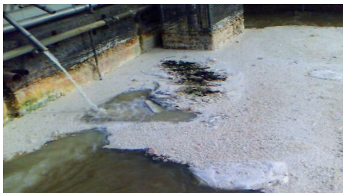
Рисунок 1: В этом отстойнике молокозавода с 1997 года осуществляется мониторинг ООУ с помощью анализатора BioTector, время работы анализатора составляет >99,7 %
