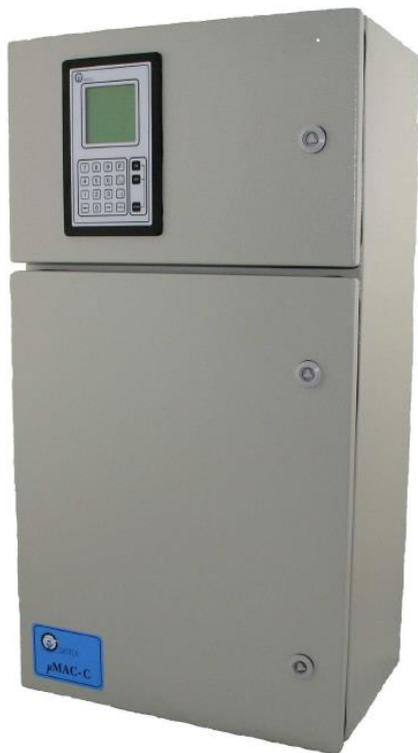
**MICROMAC C SULFATE** – это современный промышленный анализатор, управляемый микропроцессором в режиме реального времени, разработанный специально для автоматического мониторинга сульфатов в образцах сточных, природных и питьевых вод.
