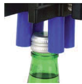
Проверка вращающего момента бутылочной крышки
