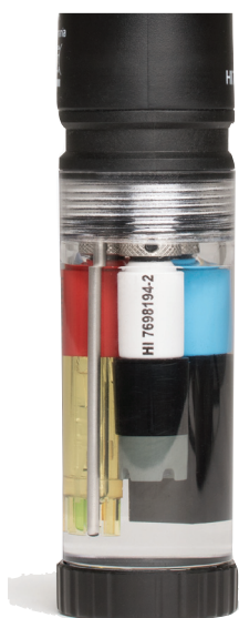
Сенсоры внутри защитной калибровочной емкости
