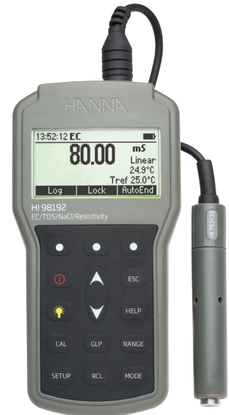
В комплекте электрод, калибровочный раствор, ПО, USB-кабель и батарейки
