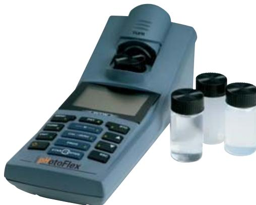
Универсальный pHotoFlex Turb аналогичен pHotoFlex, но дополнительно имеет инфракрасный источник света для нефелометрического (90°) измерения мутности в соответствии с требованиями DIN 27027/ISO 7027<sup>15</sup>. Калибровка по прилагаемым стандартам AMCO® может быть документирована через интерфейс RS232 аналогично результатам измерения.
