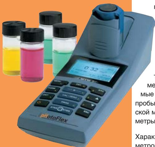
Фотометры широко применяются для анализа сточных вод, питьевой воды, поверхностных и грунтовых вод. К воде добавляются реагенты, под воздействием которых появляется специфическая окраска. Чем ярче окраска – тем больше поглощение света на определенной длине волны и тем больше концентрация определяемого элемента. Измеренная фотометром интенсивность поглощения легко переводится в единицы концентрации.
